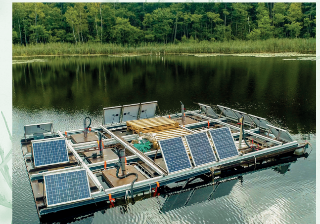
Schwimmende, solarbetriebene Anlage zur Entnahme von Phosphor aus dem Seewasser.
